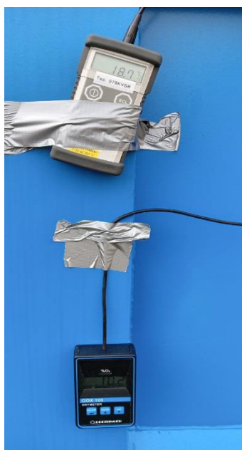
Obr. č. 16 Měření koncentrace kyslíku a teploty v kontejneru
