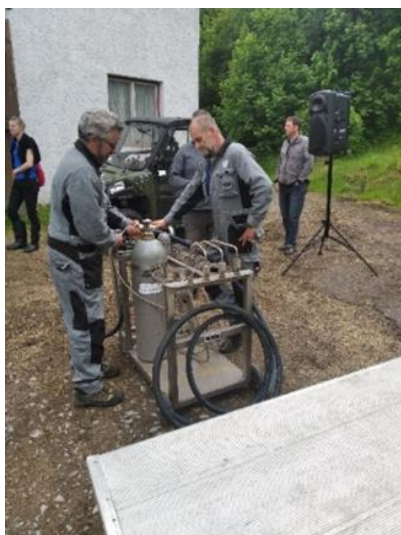
Obr. č. 16 - Vozík k utrácení drůbeže použitím CO 2
