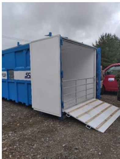
Obr. č. 14 - Kontejner k usmrcování prasat použitím CO 2
